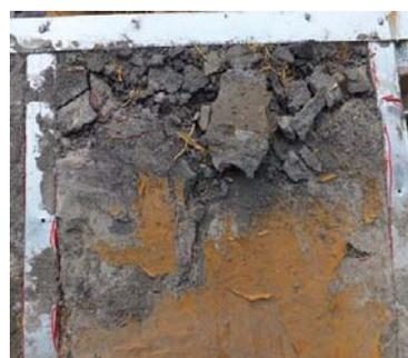
(d) Brittle failure of W-3 FC
