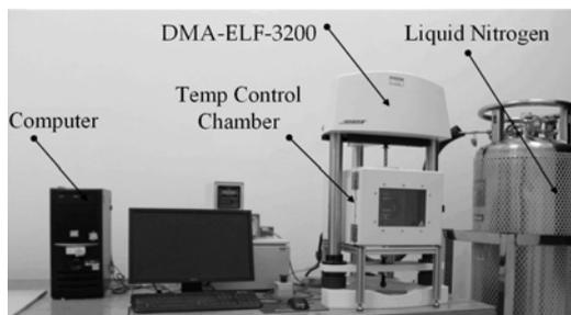
Fig. 3 DMA apparatus
