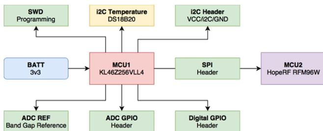
Fig. 3 Node Block Diagram
