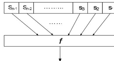
Fig. 3 Non linear filter generator
