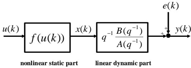
Fig. 1. Hammerstein model
