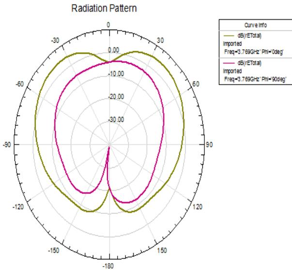
Fig. 3 (d) Simulated radiation pattern at 3.769 GHz
