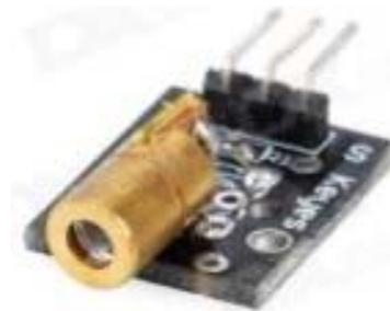
Fig. 3 Laser Module
